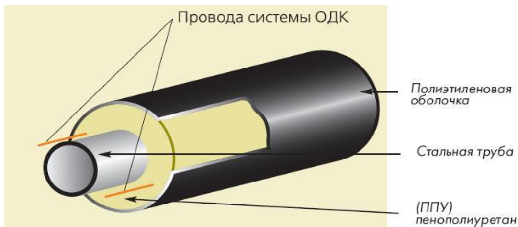
Рис. 1 Стальная труба в монолитной полиуретановой изоляции
